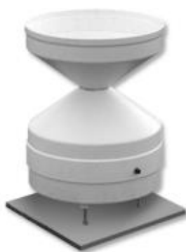
Figura 8: fotografia del pluviòmetre Campbell Scientific ARG100 (Ministerio de Agricultura y Pesca y Alimentació, 2010).
