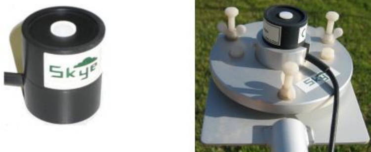
Figura 7: fotografia del piranòmetre SKYE SP1110 (Ministerio de Agricultura y Pesca y Alimentació, 2010).
