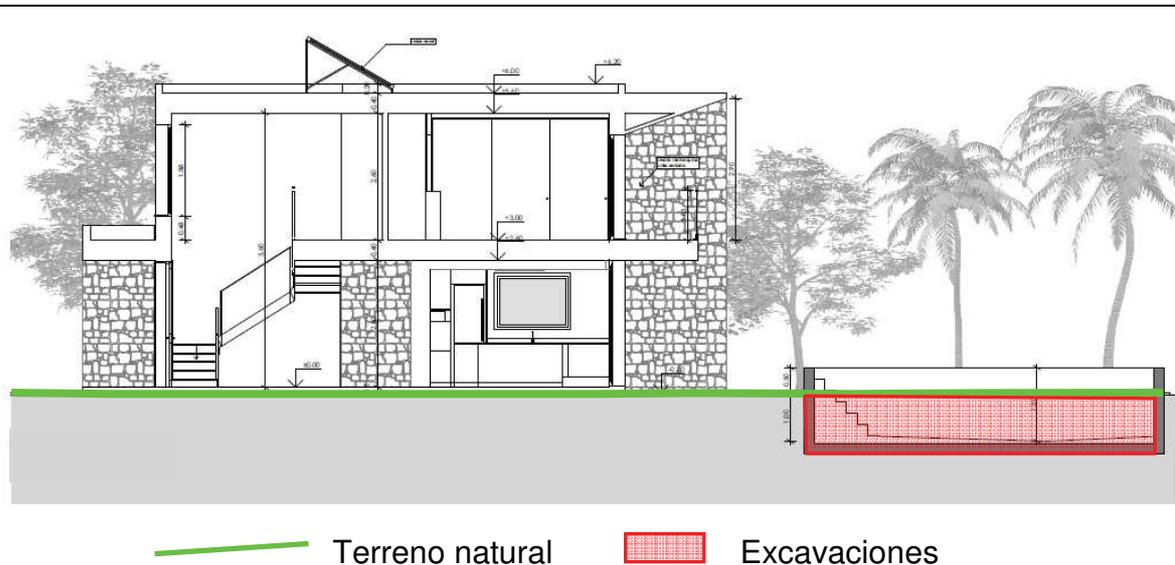
**Fuente:** Plano 04. Alzados y sección del Proyecto de Vivienda Aislada y Piscina en el Solar 4.
