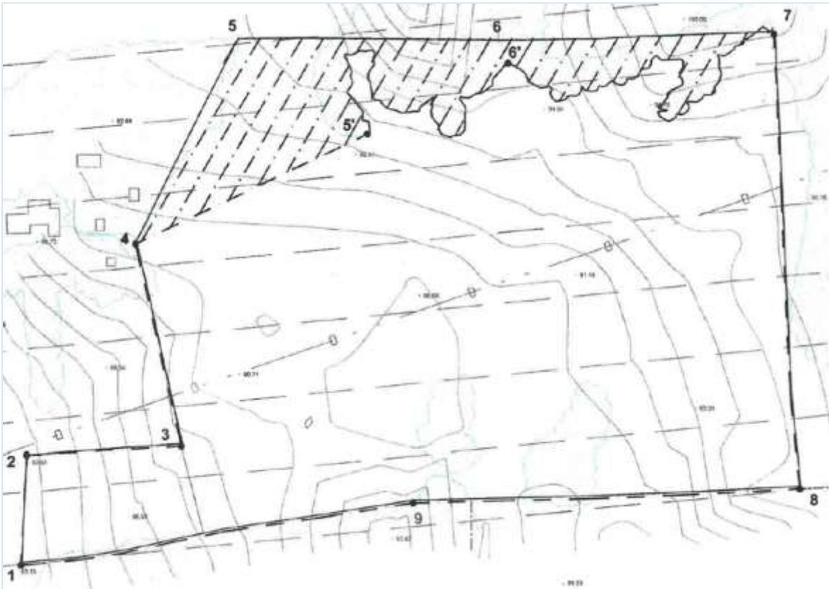
Figura 5. Diferencia entre los puntos de la poligonal inicial (5 - 6) y los modificados definitivamente (5' - 6'), según proyecto de explotación aprobado.
