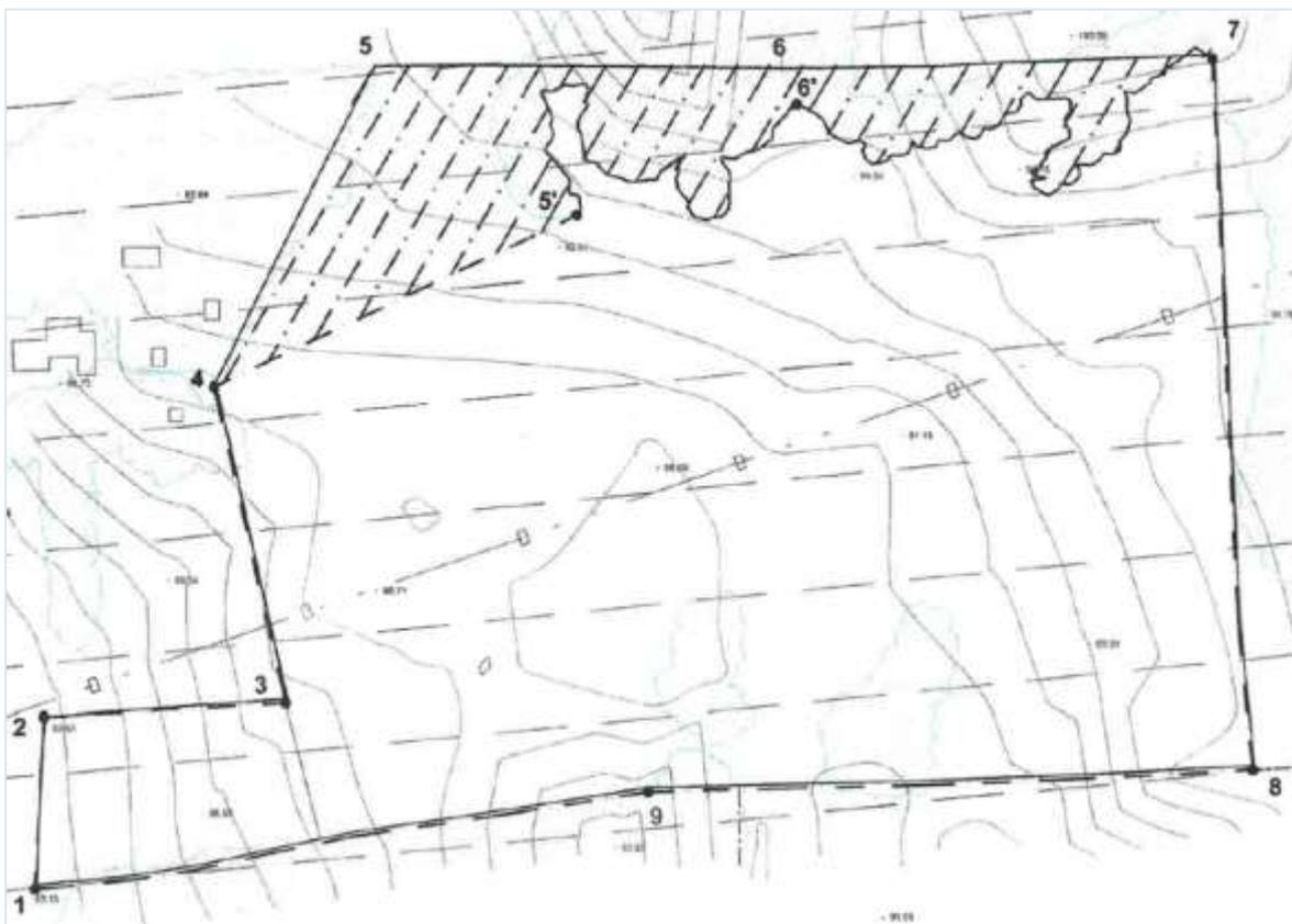
Figura 3. Diferencia entre los puntos de la poligonal inicial (5 - 6) y los modificados definitivamente (5' - 6'), según proyecto de explotación aprobado.
