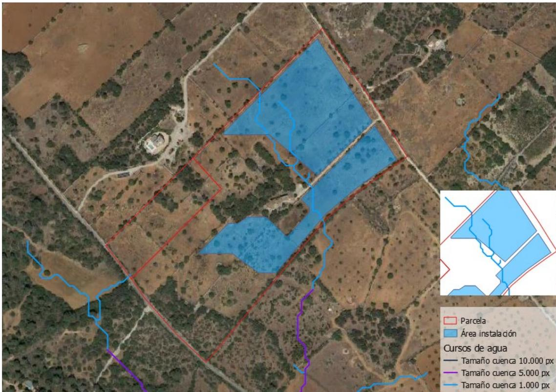
Ilustración 2 Red de drenaje detalle
