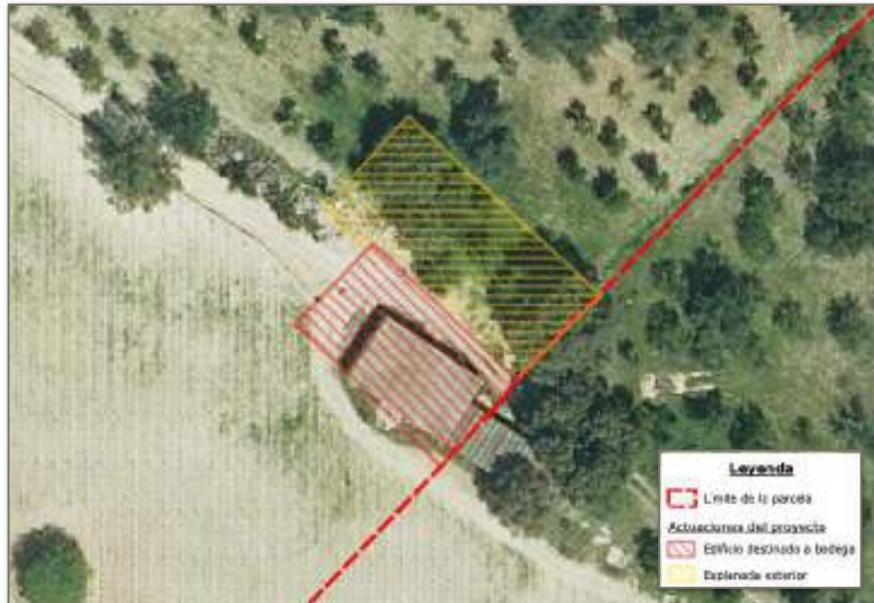
Localización del nuevo edificio destinado a bodega y de la explanada delantera, la cual se integrará con el arbolado existente. Las actuales edificaciones agrícolas, serán demolidas
