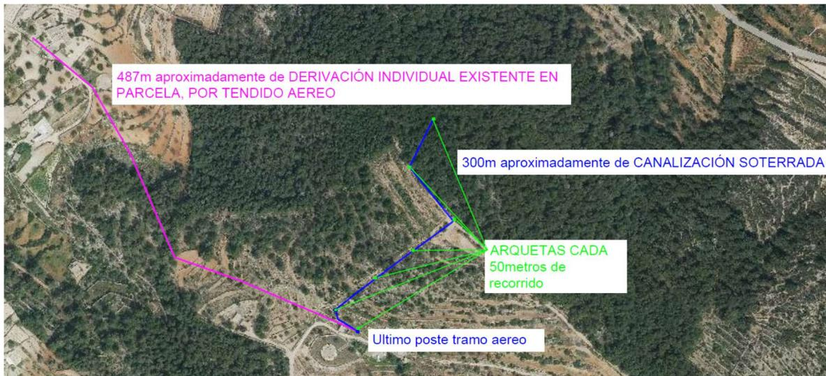
**Figura 5.** Trazado de la nueva derivación individual prevista hasta el emplazamiento, consistente en 300 m de nueva línea soterrada y 487 m de línea siguiendo un tendido aéreo existente.
