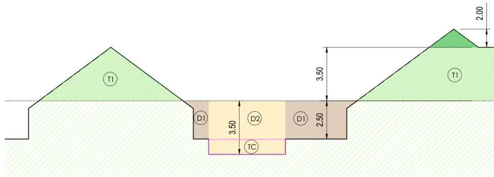
SECCION ESQUEMATICA DEL MOVIMIENTO DE TIERRAS S/E
