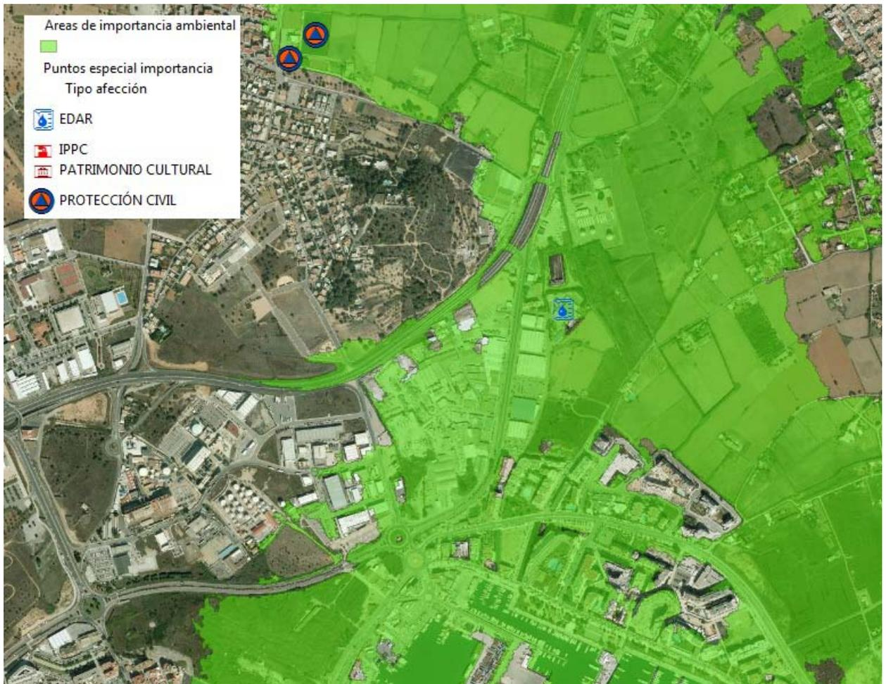
Figura 17.- Ejemplo de mapa de afección al medioambiente (puntos y áreas para T = 500 años) en el ARPSI de Llanvera.
