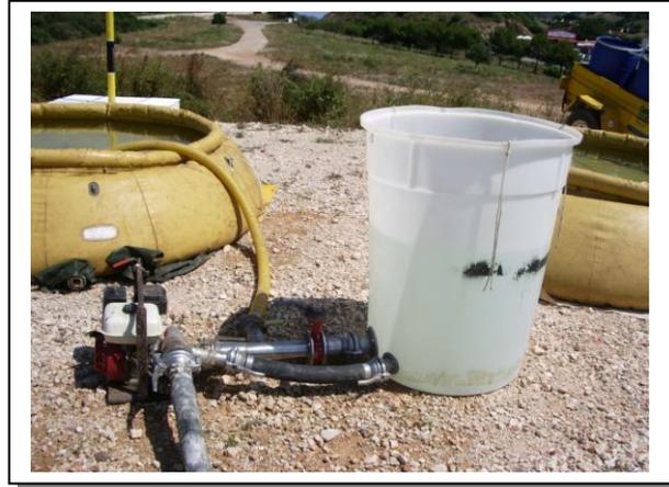
18.14 Depósito agua, bomba y depósito mezclador
