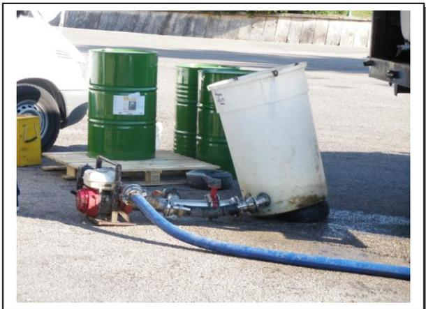
18.15 Bidones de 180 litros y depósito mezclador inclinado
