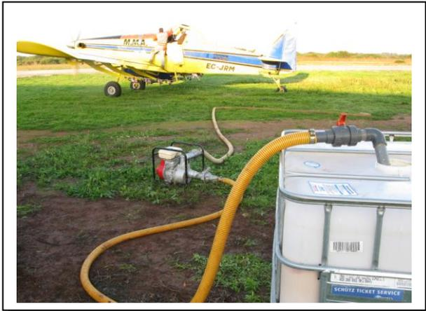
18.9 Sistema de carga. Bidón, motobomba, manguera, avión
