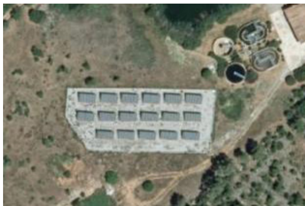
Instalación de 90 kW en el EDAR de sa Ràpita, 1.800 m 2 . Foto IDEIB.
