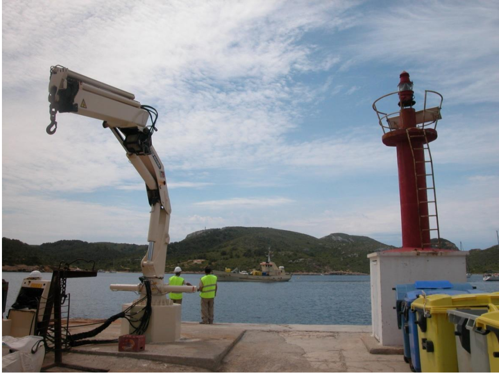
Grúa del port, equipamiento imprescindible para las operaciones de carga y descarga de material, combustible, residuos, etc.
